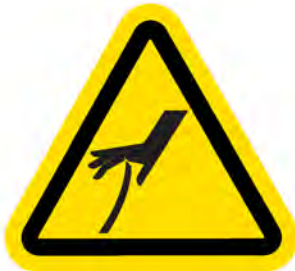
Sharp Edge Hazard
